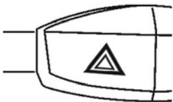
В аварийных ситуациях мигающий сигнал аварийной остановки предназначен для предупреждения впереди и сзади идущих автомобилей.
