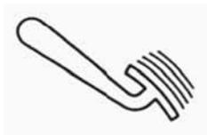
Антиблокировочная система тормозов (ABS) не задействуется при нормальном торможении. Система работает только в положениях, когда колеса предрасположены к блокировке. При этом одновременно с нажатием педали тормоза появляется характерный шум от работы системы ABS. На приборной панели загорается контрольная лампа. Шум и вибрация на педали тормоза при работе ABS является нормальным. Использование системы ABS для торможения
