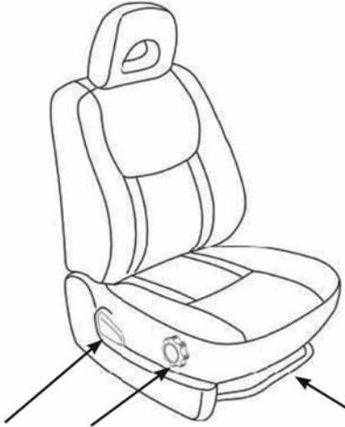
Сдвиньте сиденье вперед или назад. Чтобы сдвинуть сиденье вперед или назад, потяните вверх рычаг регулировки сиденья, до тех пор, пока сиденье не будет установлено в удобное положение. После регулировки отпустите регулировочный рычаг и попытайтесь переме-
