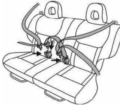
Длину данных ремней невозможно регулировать автоматически. Вставьте планку ремня безопасности (язычок защелки) в его замок до щелчка. Затем вручную отрегулируйте длину ремня и расположите его ближе к бедру.
