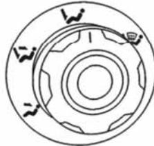
Установите переключатель режима обдува в нужное положение, чтобы система вентиляции и кондиционирования распределяла воздушный поток в направлении указанном на регуляторе режима обдува.
