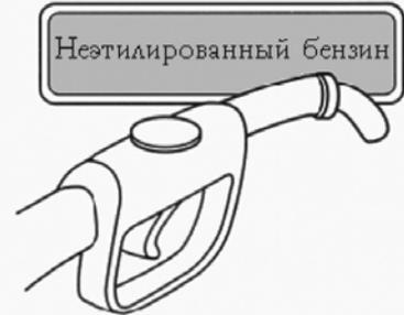
Данный автомобиль (с бензиновыми двигателями) оборудован узкой заливной горловиной, к которой подходят «пистолеты», заправляющие только неэтилированным топливом.
