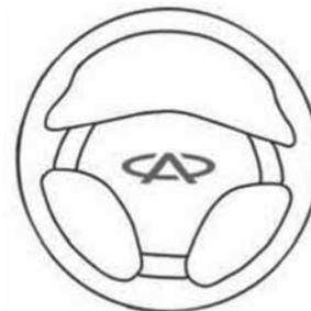
Нажмите на кнопку. Звуковой сигнал работает даже при выключенном зажигании.
