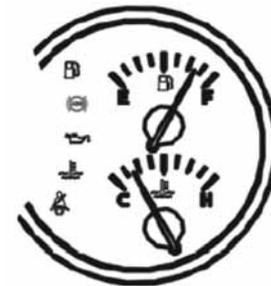
Отражает температуру охлаждающей жидкости
